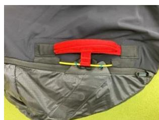
ピンの先端をカバーの中に収納してください。グリップの端もカバーに収納します。
