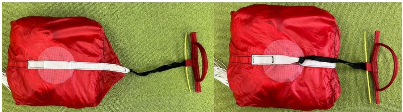
ハンドルの構造や形状は、ハーネスによって異なります。正常に開傘動作を行うため、必ず専用のハンドルを使用してください。
