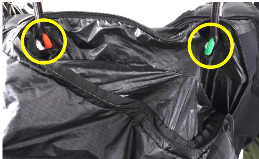
ロガロタイプなどのレスキューパラシュートを使用する場合は、十分な強度を持つレスキューリングまたはソフトリンクを使用し、正しいループに確実に取り付けてください。
