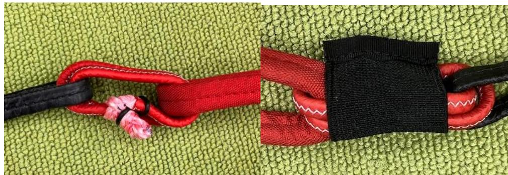
プライダルコード同士を直接接続すると、開傘時の摩擦熱によりコードが溶けて切断する可能性があります。
