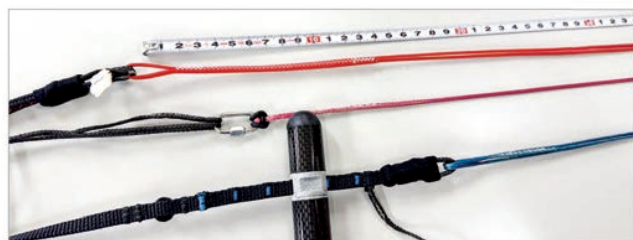
写真はXXSサイズのもので、AB間15cmの速度アップが可能
