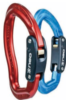
NEO AUSTRIALPIN ROCKET 破断強度:22kN、重量:64g、素材:アルミニウム、 認証: EN362。5年または500飛行時間ごとに交換。
