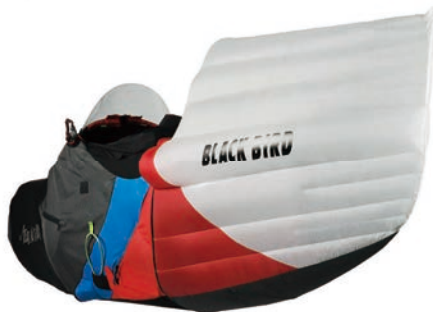
頭部や腕が生み出す乱流を整えるデザインを採用した大型フィンが、パフォーマンスを最大限に引き出します。
