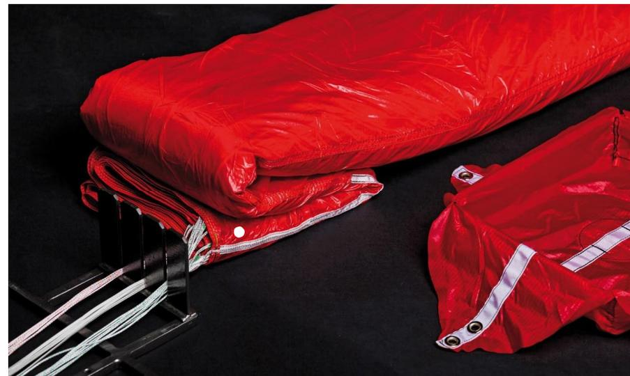
ディプロイメントバックの90%の長さでS字に折ります。サスペンションラインを収納する場所を残しておきます。
