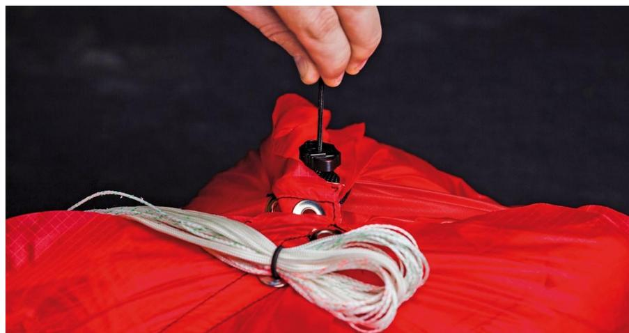
中央のバンジーコードのテンションは、ループテンショナーによって制御されています。これは、ディプロイメントバックからブライダルを引っ張ってパラシュートが展開されるように設定されています。ループテンショナーはディプロイメントバックの4番目のパネルの下にあり、テンションは黒いバンジーコードで調節されます。
