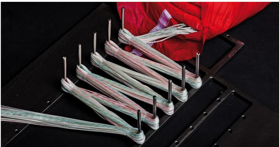
固定してあるブライダルを外します。S字にサスペンションラインを束ねていきます（ブライダルの90cm手前まで）。
