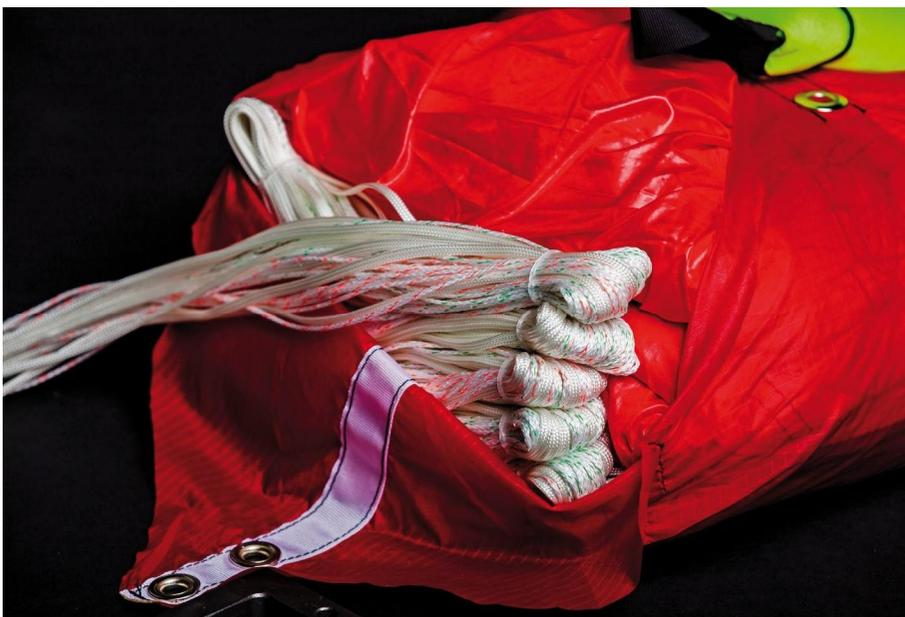
ラインをたたんだキャノピーとディプロイメントバックの間に置きます。
