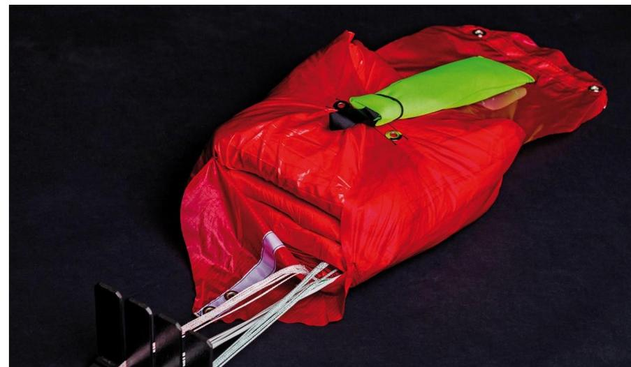
キャノピーをディプロイメントバックに置き、再び開かないようにします。
