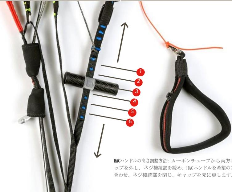
HACハンドルの高さ調整方法：カーボンチューブから両方のキャップを外し、ネジ接続部を緩め、HACハンドルを希望の高さに合わせ、ネジ接続部を閉じ、キャップを元に戻します。
