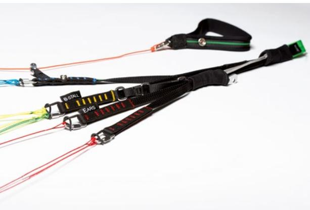
簡単に識別できるように、ライザーにもこのカラーコードを適用しています。分割されたAライザーには「Ears」と記されたラベルが取り付けられています。Bライザーには「B-Stall」と記されています。これにより、これらの操作を安全に実行できるようになります。
