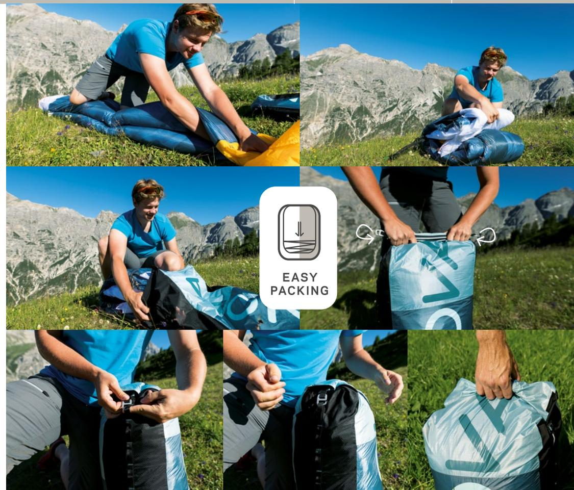
弊社の翼には、従来のパッキング方法を採用しています。つまり、翼を平らに置き、キャンピアーの上にラインを置き、中央に向かって折ります。セルの開口部が一直線になっているので、これを参考にすると良いでしょう。次に、グライダーを丸めるのではなく折ります。こうすることで、グライダーバッグに入れて運ぶときに快適になります。翼を折りたたむときは、リーディングエッジのロッドが曲がっていないことを確認してください。このシンプルで快適なパッキング方法は、ロッドを控えめに使用することで可能になりました。ロッドはプロファイルノーズにのみ使用されます。
