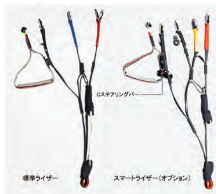
ライザーはハンドリングに優れた12mm幅のライザーが標準装備です。Cライザーステアリングが可能なスマートライザーがオプションで用意されています。
