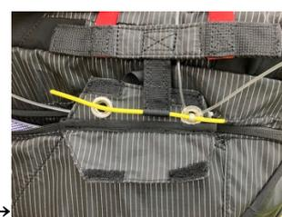
レスキューピンをループに通し、ポケットに先端を収納する。
