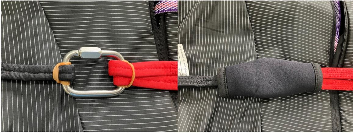
ブライダルコード同士を直接接続した場合、開傘時にブライダルコードが摩擦熱でコード溶け、切断する可能性があります。
