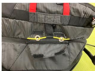
レスキューピンをループに通し、ポケットに先端を収納する。
