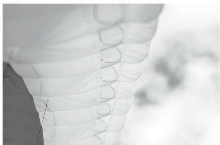
新ロッドループを採用したエアスクープとミッドセルリンクにより、リーディングエッジの安定性がさらに最適化されました。
